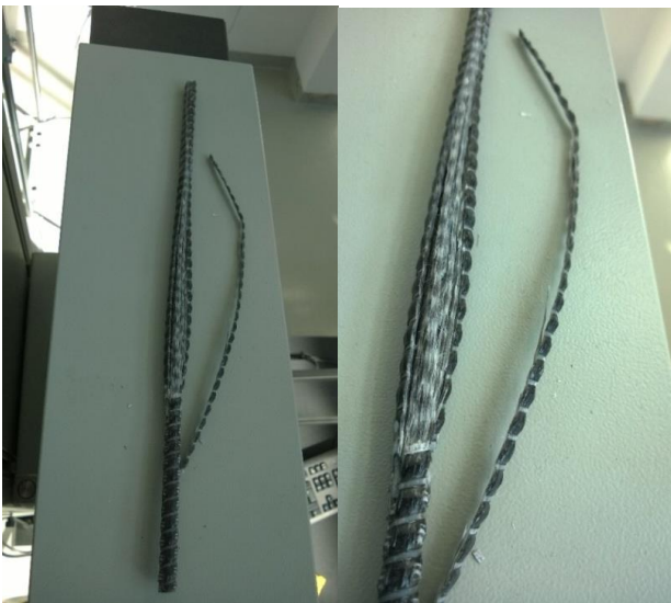
Rys. 5. Pręt BFRP po badaniach wytrzymałościowych
