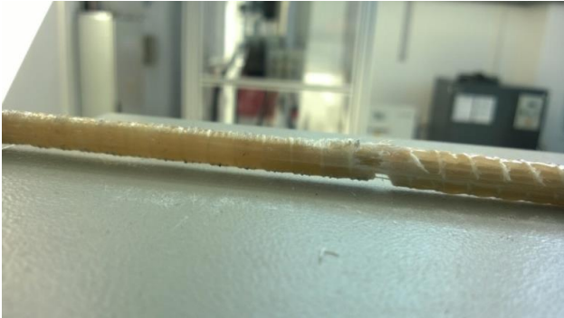
Rys. 4. Pręt GFRP po próbie rozciągania osiowego
