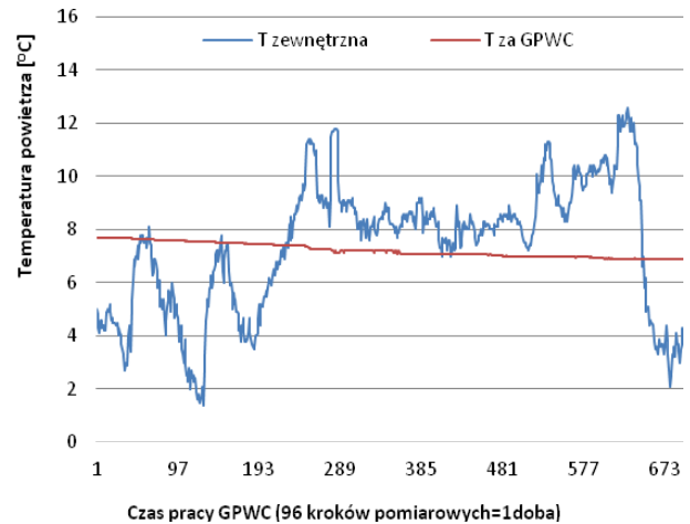
Rys. 8. Wykres temperatury powietrza zewnętrznego i po przejściu przez GWPC w grudniu 2015 roku
